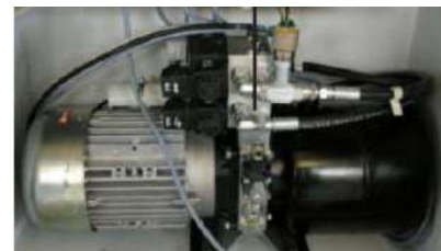
Groupe hydraulique L 600 x H 360 x P 300mm / 21kg
