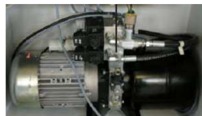
Groupe hydraulique 550 x 270 x 400mm
